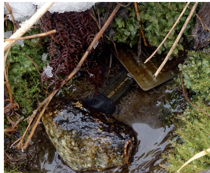
Temperaturlogger zur Messung der Temperatur im Quellwasser (rechts). Beziehung Jahresmitteltemperatur und Meereshöhe in 41 alpinen Quellen (unten).
